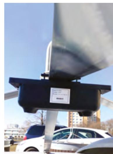
Exemple de fixation du capteur dans le conteneur
